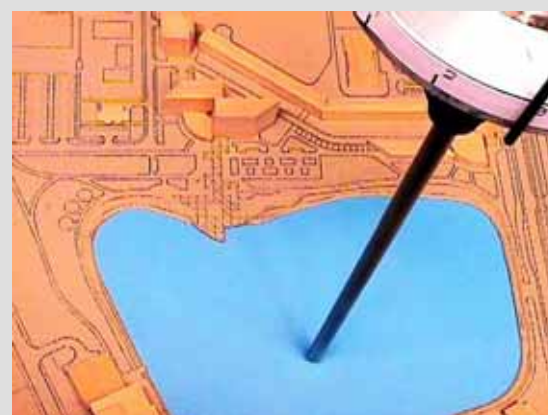
Detail úpravy hlavy upevnenia endoskopu na snímkovanie obrazov interaktívnej 360° QTVR panorámy ako archivovateľného záznamu prieskumu alebo overovania priestorovej kompozície na reálnom fyzickom modeli.
