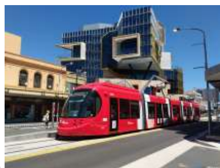
Električka bez trolejov Inekon, ČR, 2015; Newcastle (Austr.) električka bez trolejov, akumulátor sa nabíja na zastávke
