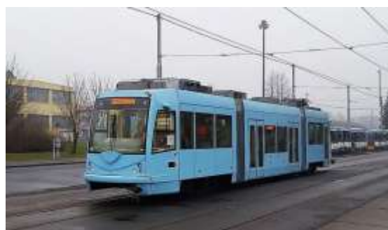
Električka bez trolejov Inekon, ČR, 2015; Newcastle (Austr.) električka bez trolejov, akumulátor sa nabíja na zastávke
