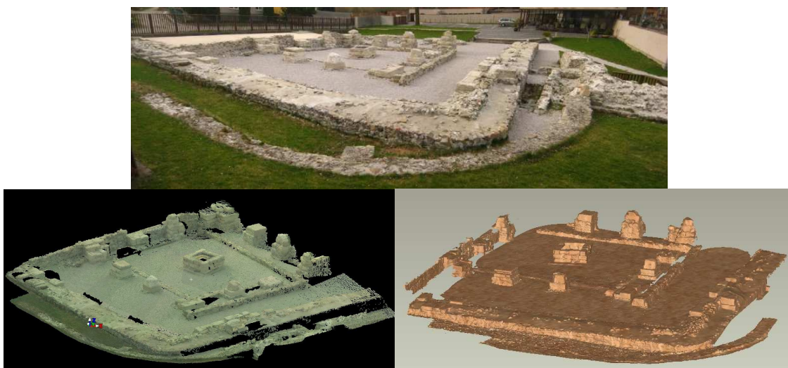
Obr. 2. Hradby (hore), mračno bodov (dole vľavo) a 3D model (dole vpravo)
