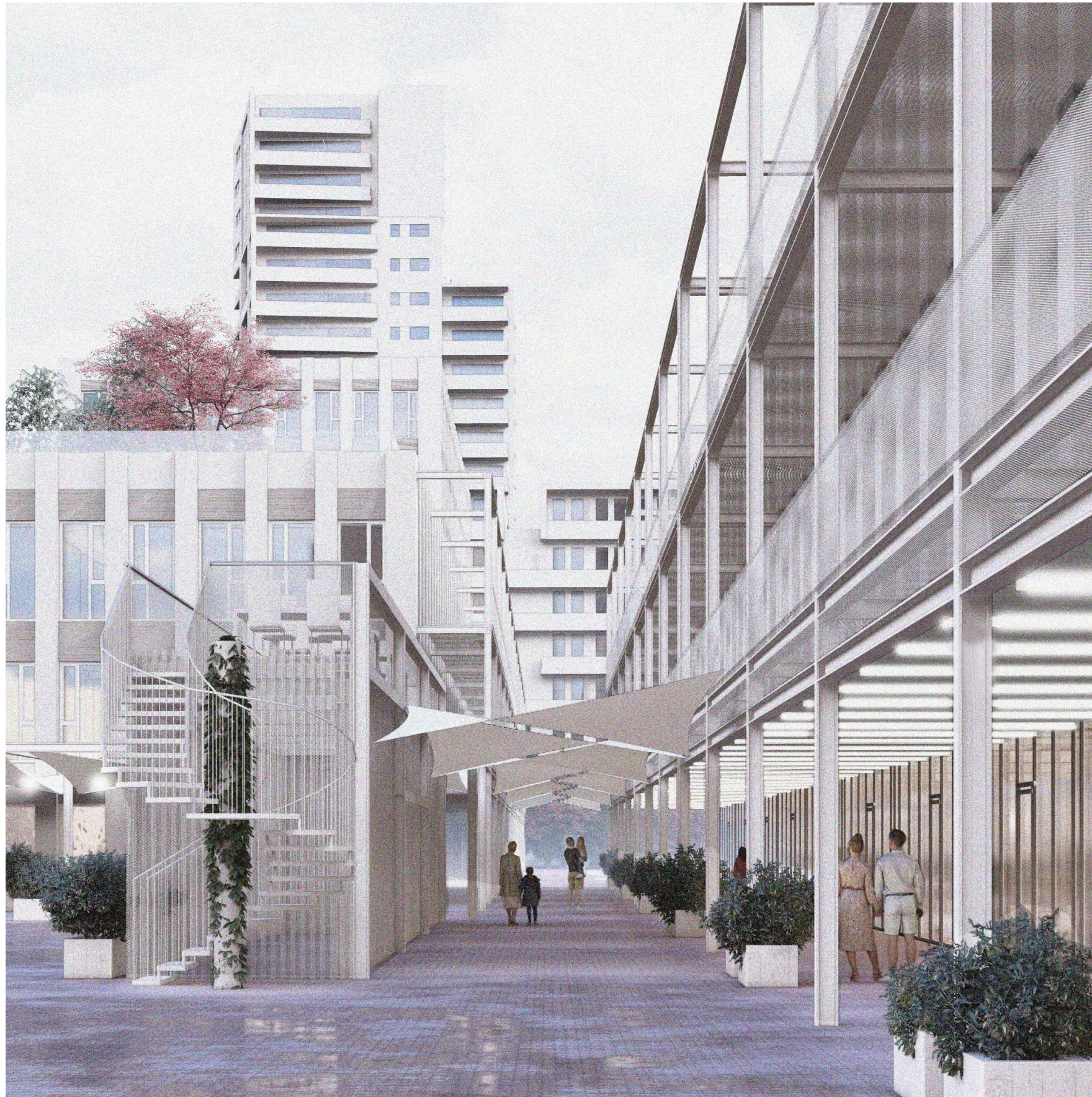
– pohľad do obchodnej pasáže – návrh počíta s realizáciou novej ľahkej balkónovej konštrukcie formou náznakovej rekonštrukcie, ktorá má za úlohu prevzdušniť a presvetliť priestor (kombinácia ocelejovej konštrukcie s transparentnými zábradliami a podlahami a membránového prestrešenia)
