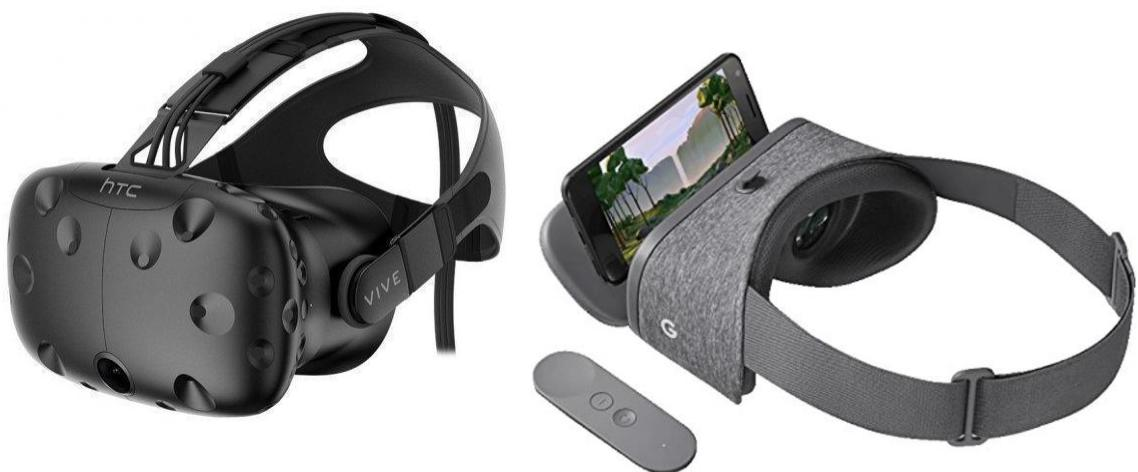
Obrázok 71: Okuliare so zabudovaným displejom, HTC Vive (vľavo). Okuliare bez zabudovaného displeja, s mobilným telefónom. Google Daydream (vpravo). Zdroj: HTC, Google.
