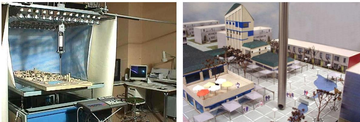
Obrázok 31: Simulačné zariadenie Opto-elektronické simulačné zariadenie s grafickým výstupom na monitore PC alebo dataprojektore a interakcia endoskopu v prezentačnom modeli M 1 : 200 (Foto: P. Kardoš, Zdroj: Autori)
