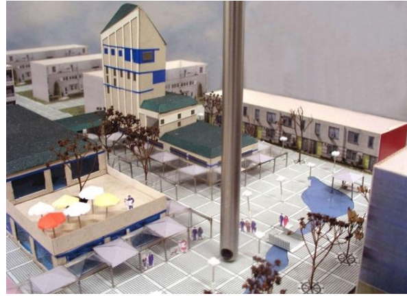
Obrázok 34: Simulačné zariadenie Opto-elektronické simulačné zariadenie s grafickým výstupom na monitore PC alebo dataprojektore a interakcia endoskopu v prezentačnom modeli M 1 : 200. Zdroj: P. Kardoš. www.stuba.sk/sk/vyskume/dalsie-laboratoria-a-vyskumne-pracoviska-stu/laboratorium-modelovej-simulacie.html?page_id=7836
