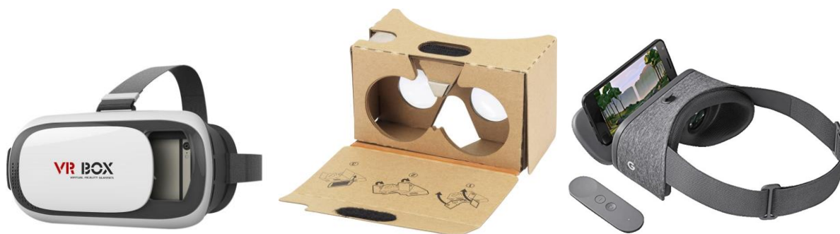
Obrázok 129: Príklady okuliarov VR pre mobilný telefón – vľavo: bez ovládania, v strede: s ovládaním prenosom dotyku a vpravo: s dodatočným ovládaním. Zdroj: Aligator, Google.
