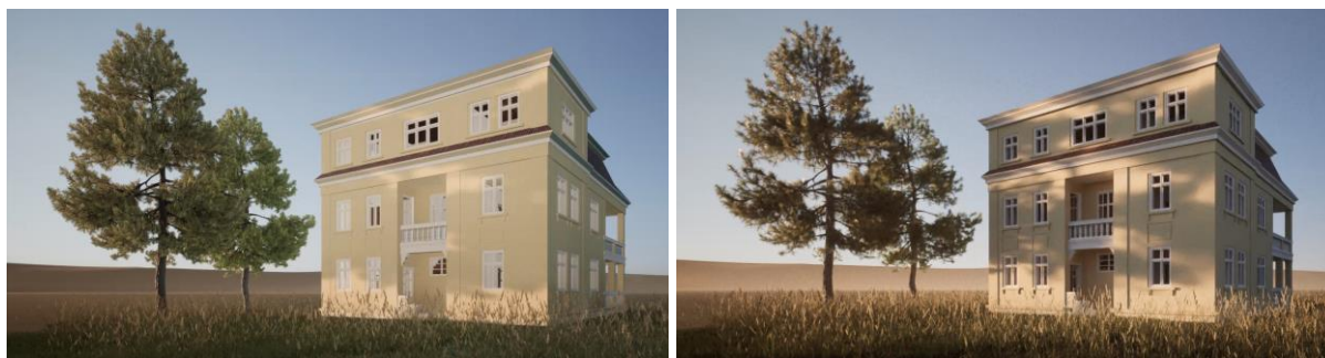
Obrázok 90: Rovnaká scéna vyrenderovaná oboma módmi renderovania. Vľavo: Real time render – zjednodušenie odrazu svetla spôsobuje jednoliate tieňovanie, obraz pôsobí plocho. Vpravo: Path tracer. Zdroj: Autori.
