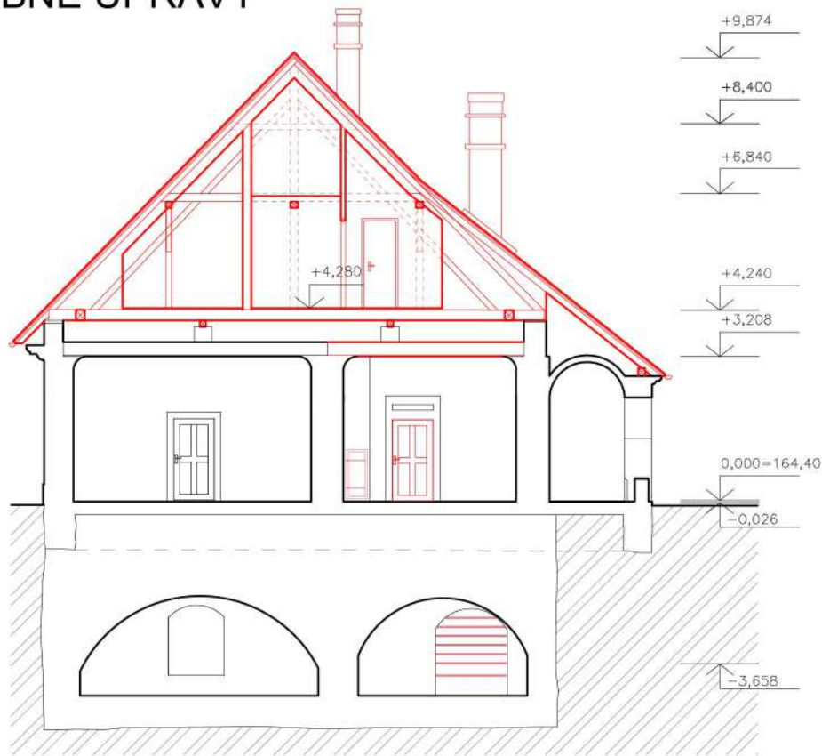
REZ B-B' STAVEBNÉ ÚPRAVY
